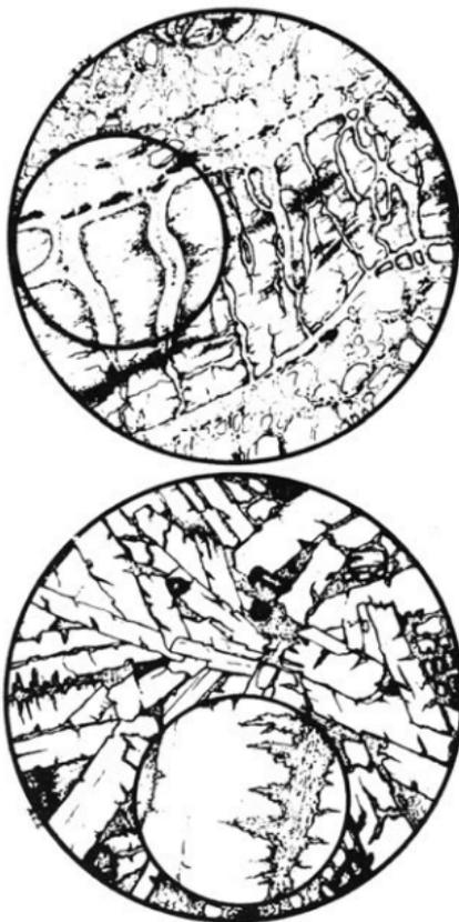
GRAFICO 3.- Fig. a) Pseudomorfo, de bastita según broncinita bordeado por finos granos de magnetita. El detalle muestra reemplazo parcial del talco. Tamaño del cristal: 2 mm. Fig. b) Rosetas de antofilita en el núcleo de broncinita no serpentinizada. El detalle muestra reemplazo parcial por talco. Tamaño de la antofilita: 0,8 mm.
