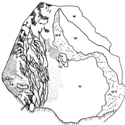
Fig. 4.— Sección traksversal de un cristal de Wolframita c, cuarzo; wa, wolframita alterada; p, powellita; w, wolframita. Aumento x 8.
